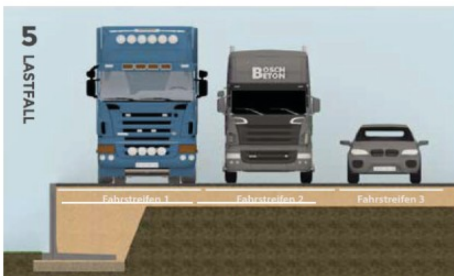
Randabstand \geq 1,00\text{m} . Fahrstreifen 1: TS = 300 kN Achslast (40,00 kN/m 2 ); UDL (12 kN/m 2 ) Fahrstreifen 2: TS = 200 kN Achslast (26,67 kN/m 2 ); UDL (6 kN/m 2 ) Fahrstreifen 3: TS = 100 kN Achslast (13,33 kN/m 2 ); UDL (3 kN/m 2 )
